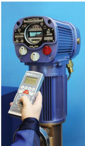
Рисунок 7 — Диагностика состояния арматуры с помощью привода «РэмТЭК»
